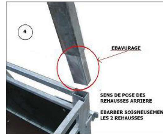
2 EBAVURAGE EBARBER SOIGNEUSEMENT L'INTERIEUR DES 4 ANGLES DE LA REMORQUE AVANT LA POSE DU PORTE ECHELLE A L'AVANT AINSI QUE DES REHAUSSES ARRIERE
